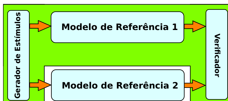
Figura 2.2: Testbench VeriSC: Validação do Modelo de Referência
